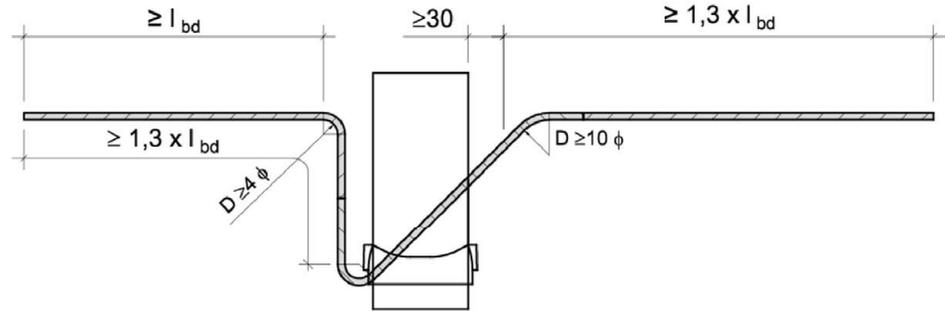
Fig. 44: Schöck Isokorb® type K / K-F (Version segmented)
